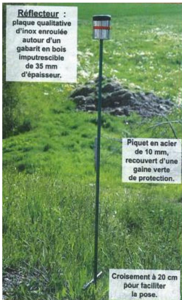
Photographie d'un dispositif anticollisions
